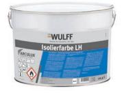
spritzfähig. Arculux® Isolierfarbe LH ist auch für die Verarbeitung mit Airless-Spritzgeräte geeignet. Bei Anstrichausführungen mit Streichwerkzeugen oder im Rollverfahren auf gleichmäßiges Auftragen und Verteilen des Materials achten. Um Ansätze bei größeren Flächen zu vermeiden, ist ein zügiges Beschichten nass in nass erforderlich. Vor Gebrauch gut umrühren. Bei Airless-Spritzauftrag Material ggf. durchsieben.
